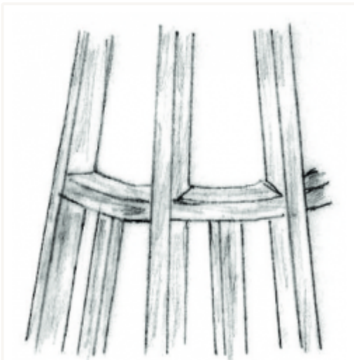
Entretôise en segment d'arc placées entre les chevrons de la charpente conique.
