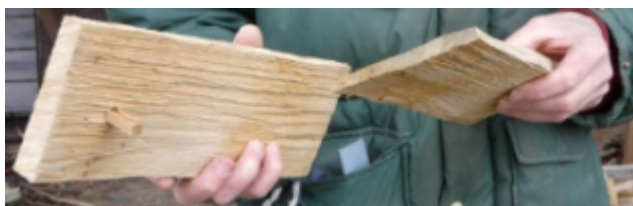
Bardeau avec pointe enfoncée.
