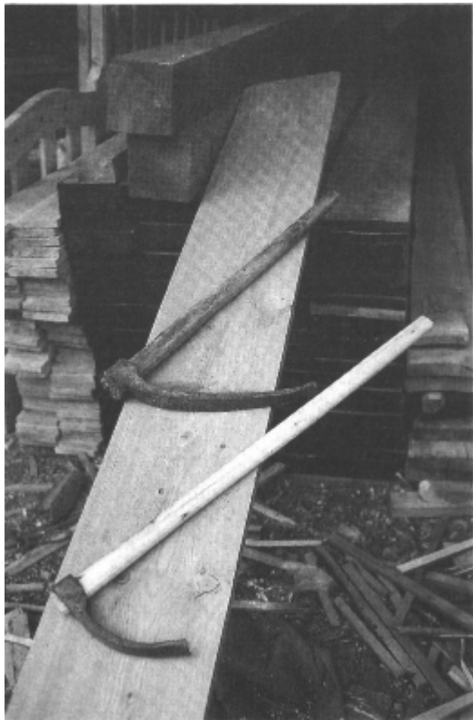
Outils nécessaires au creusement d'une planche en gouttière.
