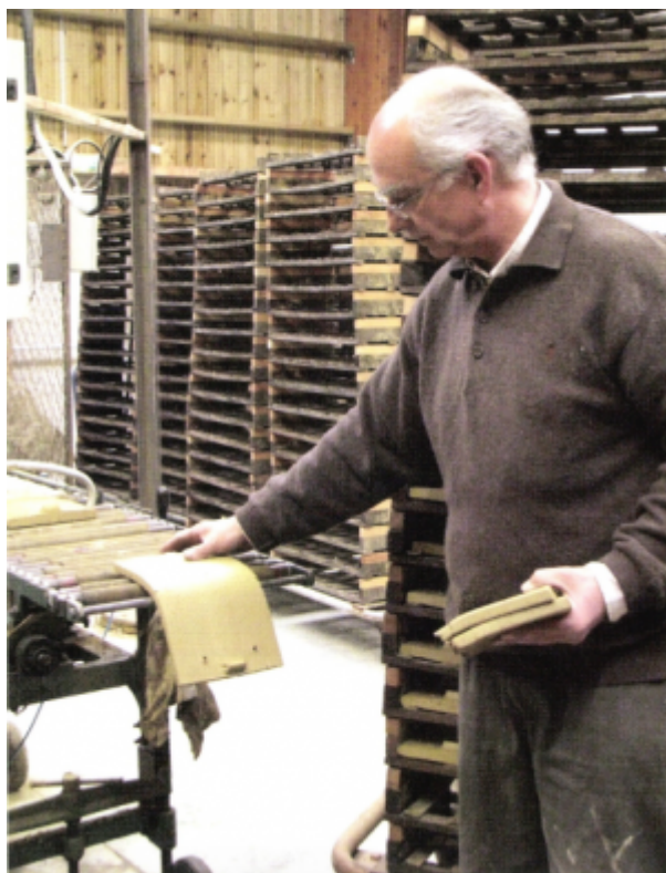
Tuile plate à la fin de la filière de production
