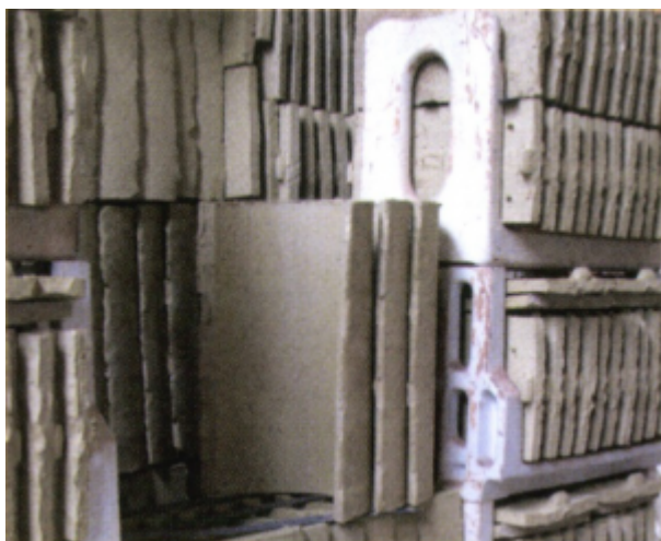
Tuiles sur cassettes avant cuisson
