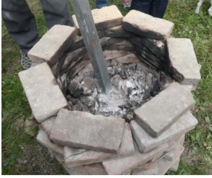
Test de cuisson du gypse à l'aide d'un piquet. Photo Maisons Paysannes des Pays de Savoie © 2019.
