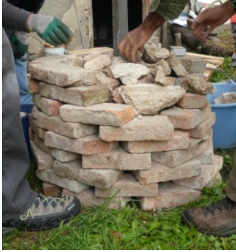
Mise en place du gypse dans le four. Photo Maisons Paysannes des Pays de Savoie © 2019.
