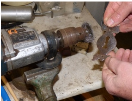
Perceuse électrique avec tête en brosse métallique. Photo Christophe Barroy © Maisons Paysannes de France, délégation de la Sarthe.
