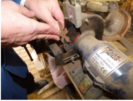
Touret à meuler brossant une pièce en fer. Photo Christophe Barroy © Maisons Paysannes de France, délégation de la Sarthe.
