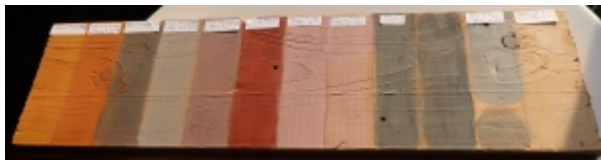
Essais de cire et terres colorantes sur du bois.
